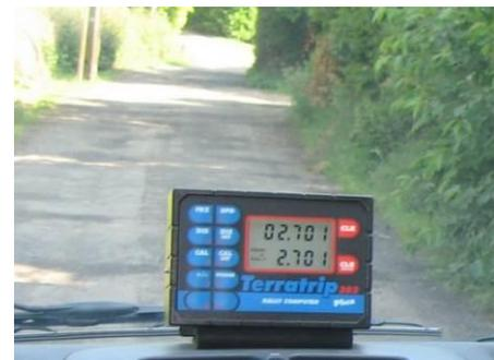
Figura 46: Un contachilometri utilizzato per individuare le carenze - fonte BRRC
