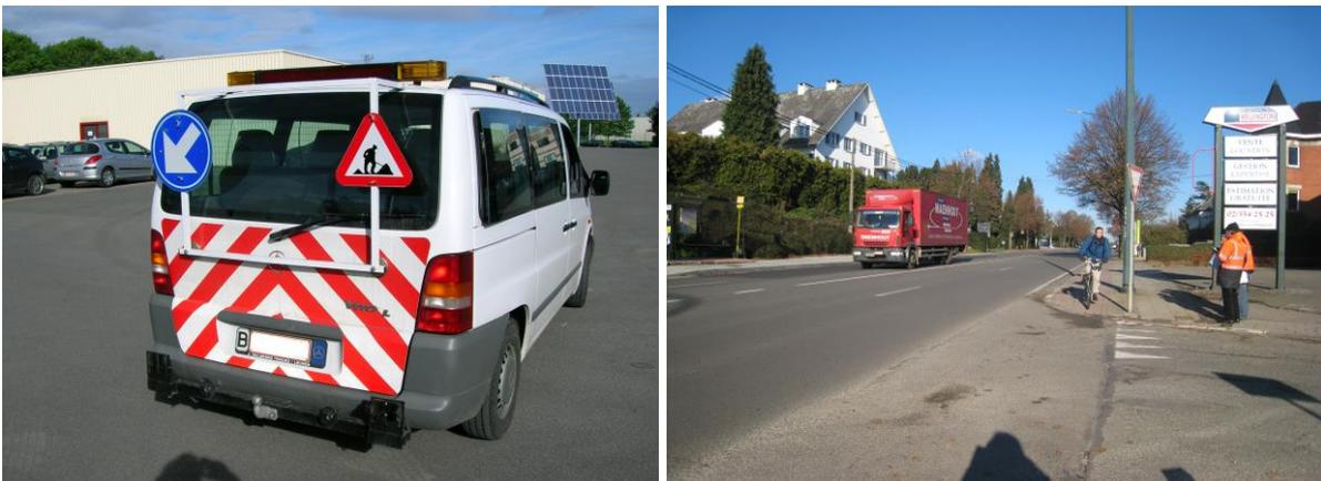
**Figura 47: Macchina di ispezione con luci lampeggianti e triangolo di emergenza (sinistra) - Ispettori con giubbotto catarifrangente (destra) - fonte BRRC**
