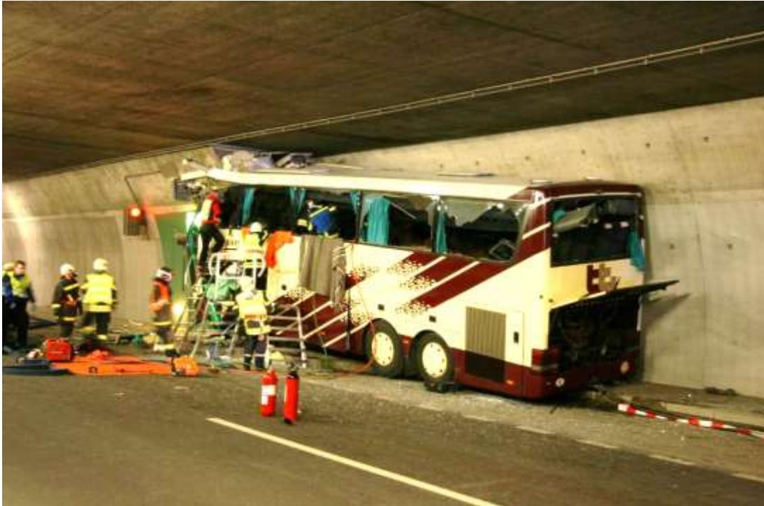
**Collisione contro il muro terminale di una piazzola di sosta in galleria, posto a 90 gradi rispetto alla direzione di marcia, senza adeguata protezione**
